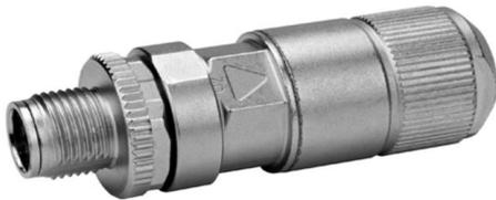
M12 Xコードコネクタ、I D C結線方式を採用した 専用工具不要なフィールドアッセンブリコネクタです。嵌合部には、振動による戻り防止機能を搭載。金属製ボディで 360°全方位シールド、Cat6A、PoEなど 幅広い産業アプリケーションでご使用いただけます。産業用ロボット・カメラ・自動化システム・自動車生産設備など 作業を止めない、止まらないシステムの接続部品
